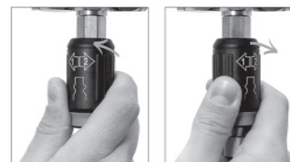
1. desahoga el lado del niple 2. desconecta
